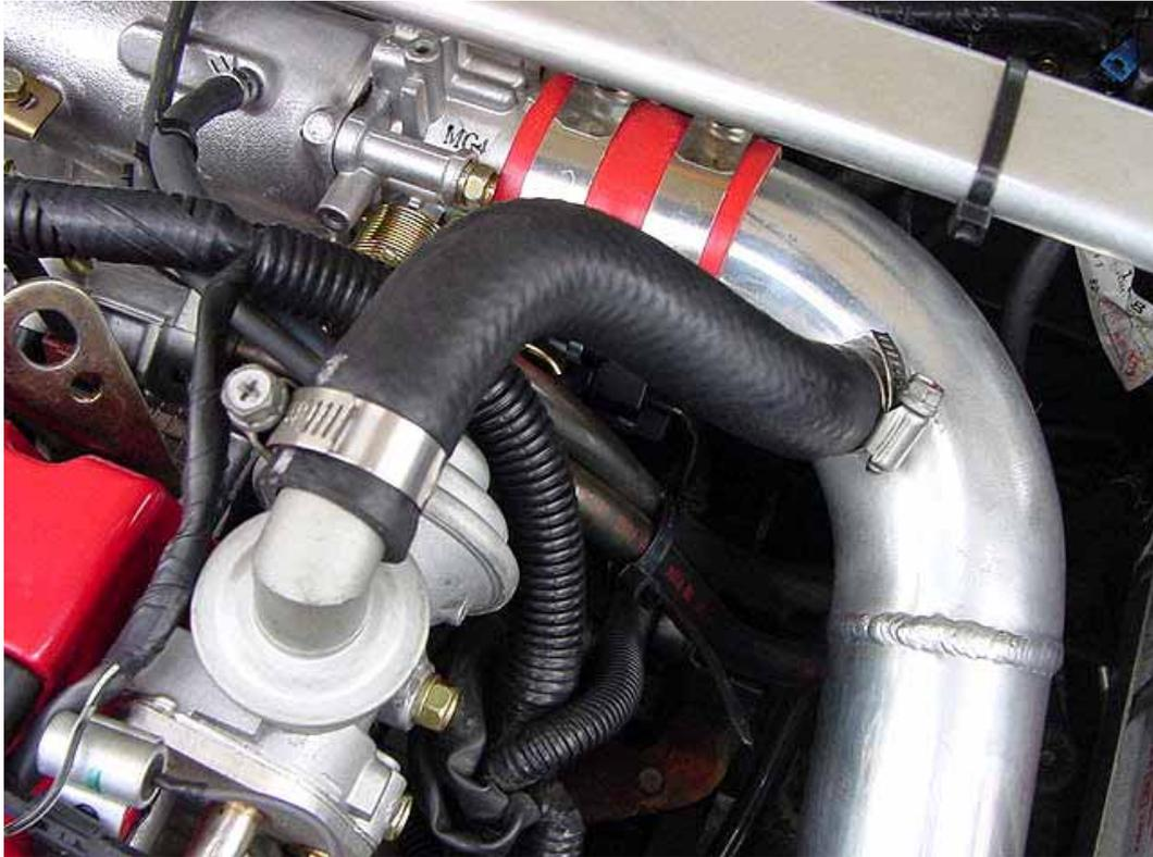
インテークパイプのサージタンク側はクランプコの耐圧バンド×2で固定してください。
